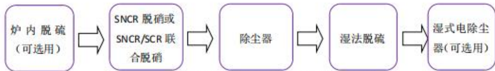
图 2 超低排放工艺流程 2（循环流化床锅炉）
